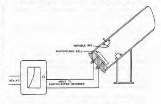
SIMPLE SCHEMATIC OF PHOTOVOLTAIC CELL AND RECORDER
